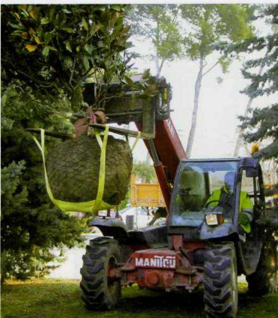
Levantamiento adecuado del árbol por el cepellón, con el uso de una eslinga de izado de cepellones, que facilita la plantación
